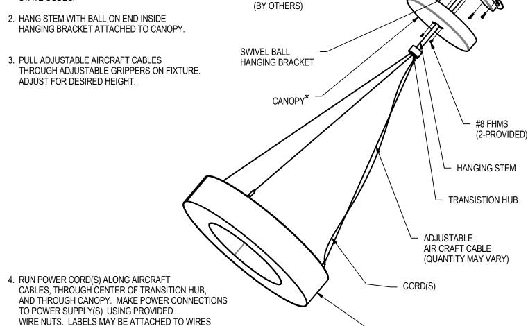
5. FASTEN CANOPY OVER HANG BRACKET USING #8 FHMS PROVIDED.
